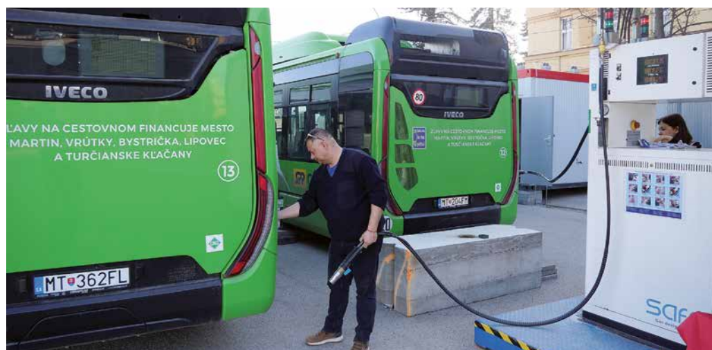
Autobusy jazdia na na CNG pohon, stlačený zemný plyn. Vo vozovni sa využíva mobilná čerpacia stanica. Pevná by mala byť k dispozícii o pár mesiacov, prístupná bude aj verejnosti. Foto: Roman Kopka
